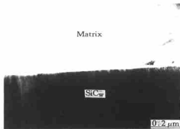
图 2 SiC w /MgLi 8 Al 1 复合材料的界面透射电镜照片
