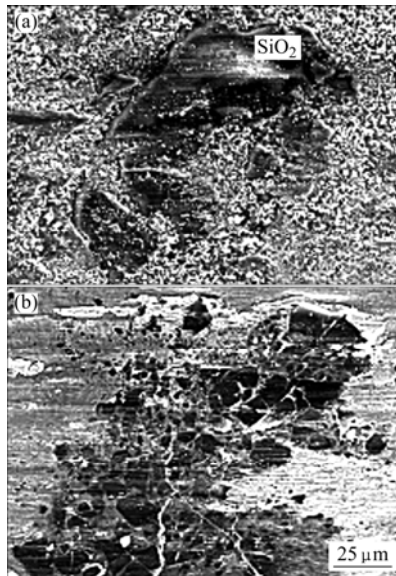
图 4 在摩擦速度 200 r/min 和 3 000 r/min 条件下 SiO 2 颗粒的形貌
