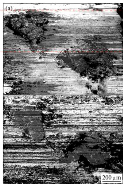
图7 摩擦时间对摩擦表面 SiO 2 颗粒的影响
