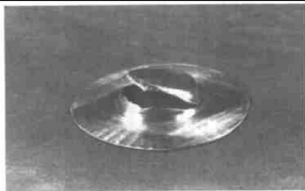
图 7 冲头温度过低导致的断裂
