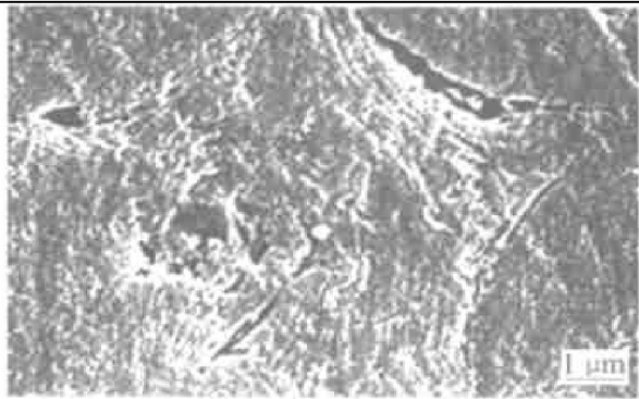
图 8 焦炭颗粒对炭基体组织的影响 Fig. 8 Influence of coke particles on carbon matrix microstructure
