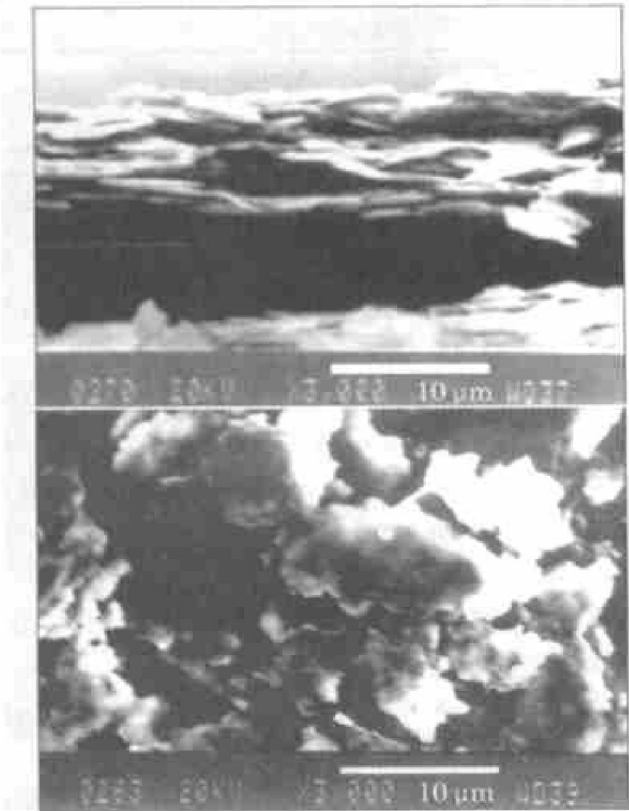
图 7 3 号样品刮样墨层横截面和 正面铜金粉片的微观形貌
