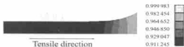
图 1 单向拉伸试样断裂时厚度分布
