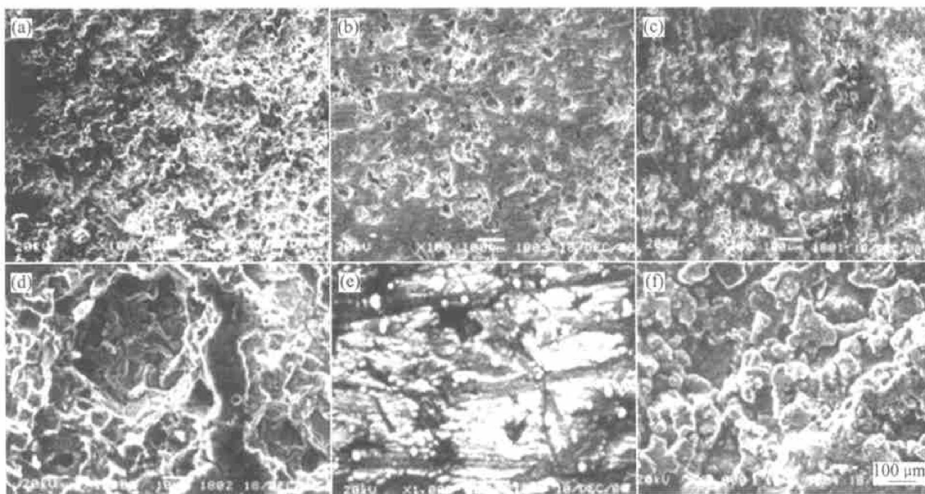
图 4 样品在 3.5% NaCl 溶液中腐蚀后的 SEM 像
