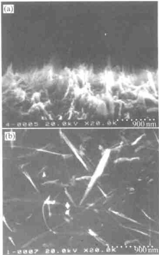
图 2 碳纳米管/镍基复合镀层的 SEM 像
