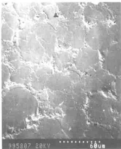
图 2 SZ(1250) 复合材料抛光腐蚀组织
