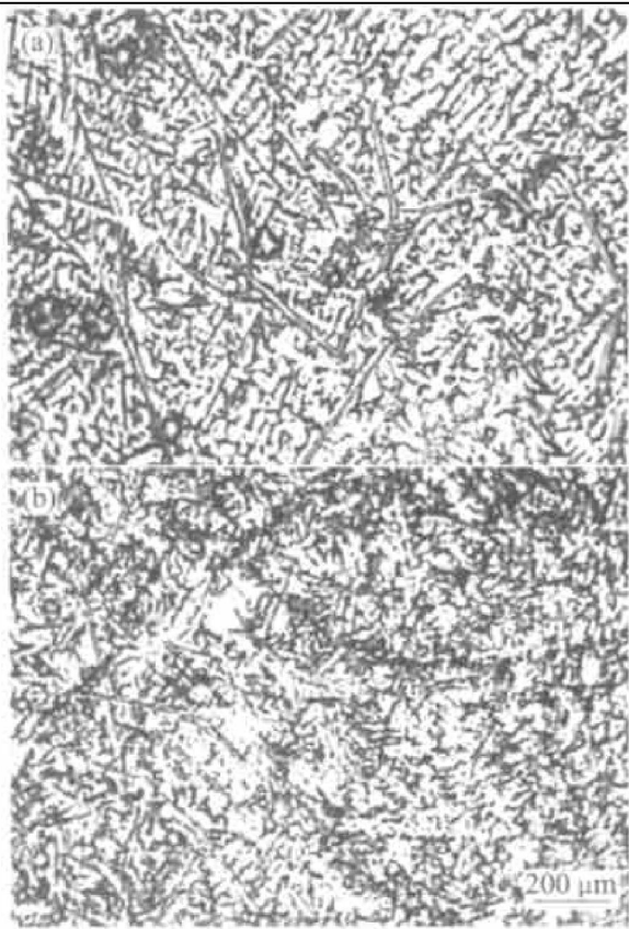
图 7 原始坯料的显微组织 Fig. 7 Microstructures of original billet (a) —Center; (b) —Border
