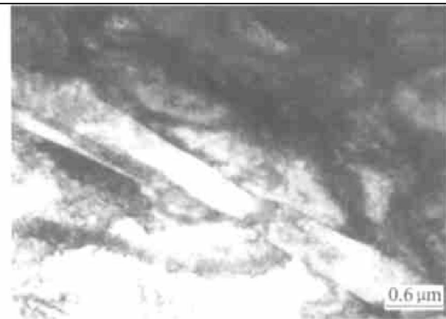
图 11 应力为 368 MPa 时试样的 集中塑性变形区 TEM 形貌
