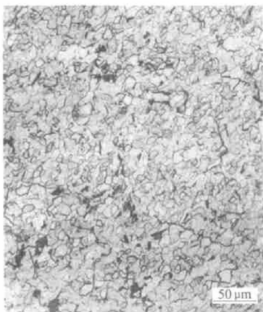
图 4 含氢 280 \mu\text{g/g} 的 Ti-4Al-2V 的组织及氢化物
