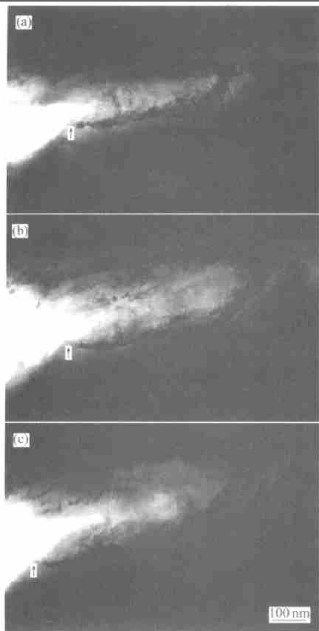
图 4 裂纹从原裂纹顶端连续扩展
