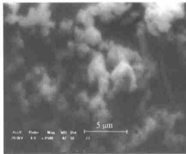
图 4 \text{LiNi}_{0.95}\text{Al}_{0.05}\text{O}_2 的 SEM 照片
