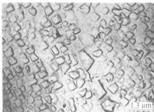
图 5 1 200 °C, 3 h 热处理后 \gamma' 相形态
