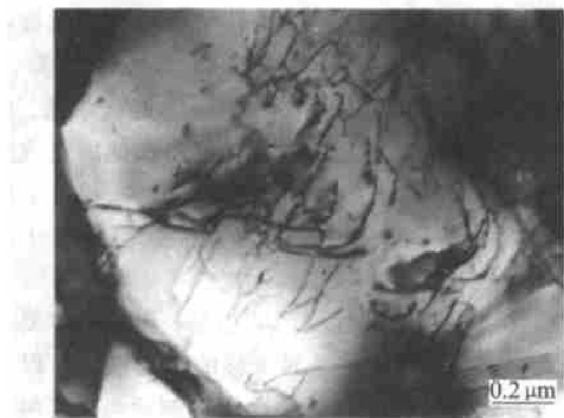
图7 TiAl基合金在 900 °C超塑性变形时的位错形态
