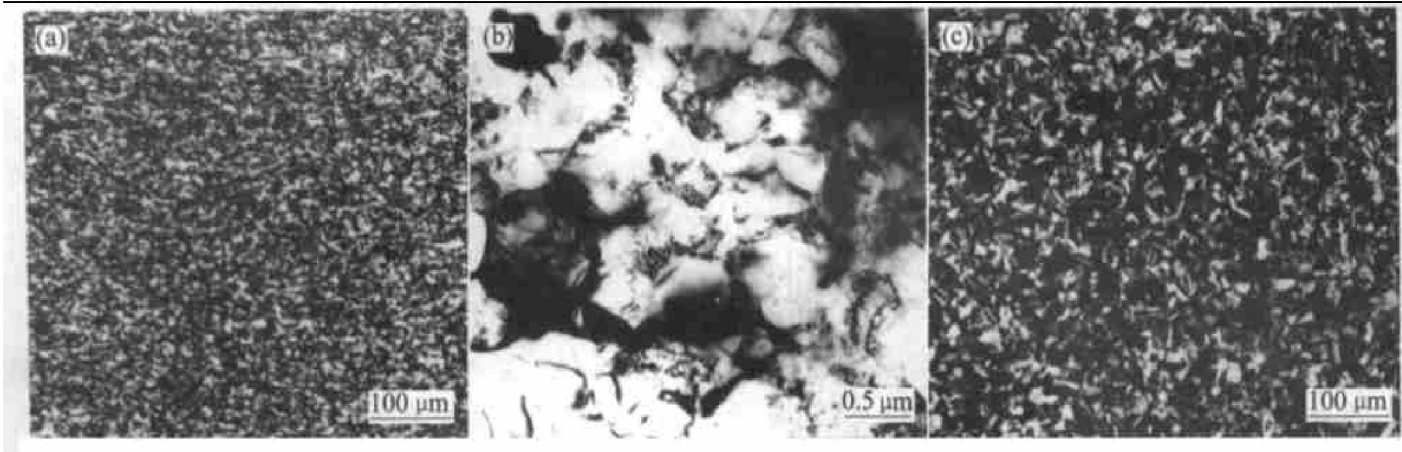
图 1 超塑性变形前 TiAl 基合金变形组织的金相(a)和透射电镜照片(b), 双态组织的金相照片(c)
