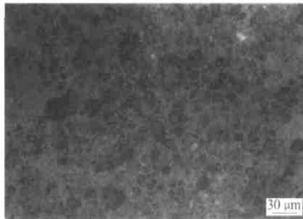
图 8 高岭石与六偏磷酸钠作用后在矿浆中的形态图 (pH= 6.28)
