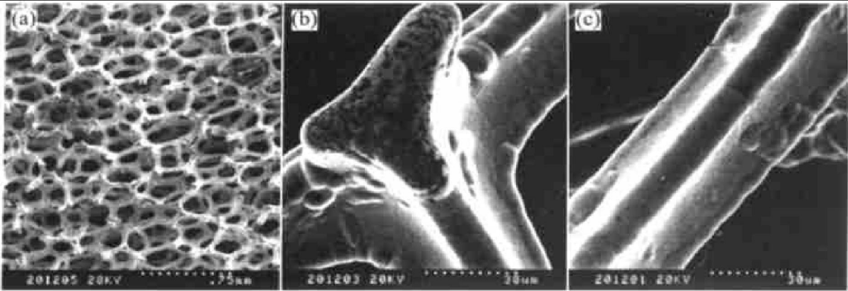
图 13 用化学镀镍法制造泡沫镍的表面形貌
