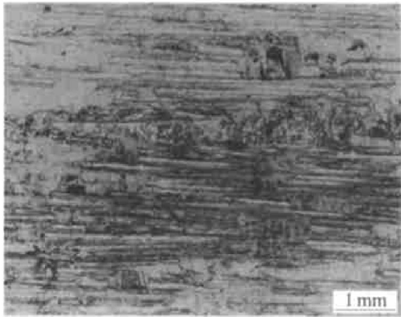
图 5 A 6 试样摩擦表面的显微组织
