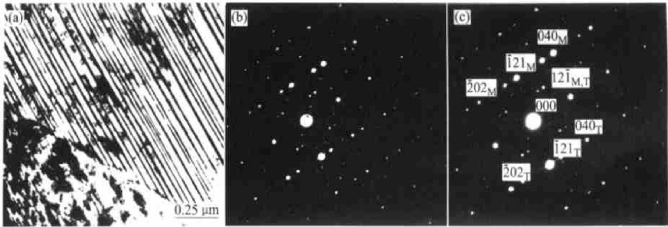
图 1 实验合金明场像及相应的电子衍射花样
