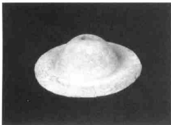
图 9 晶粒尺寸为 5.9 μm 的超塑胀形件
