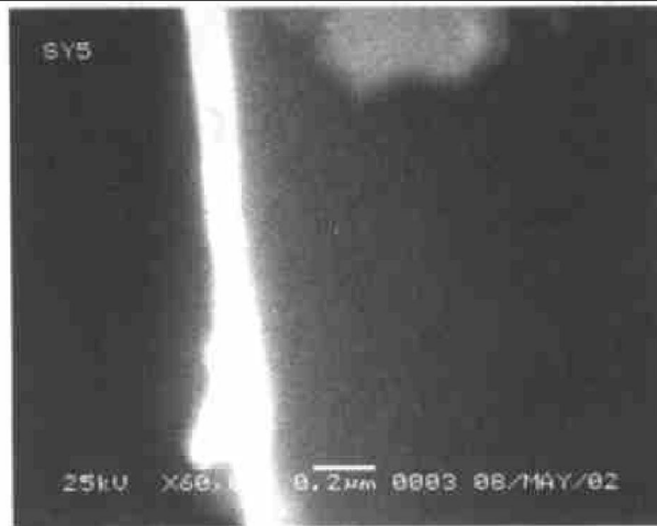
图 1 TiO 2 薄膜断面 SEM 照片 Fig. 1 SEM image of TiO 2 film cross section
