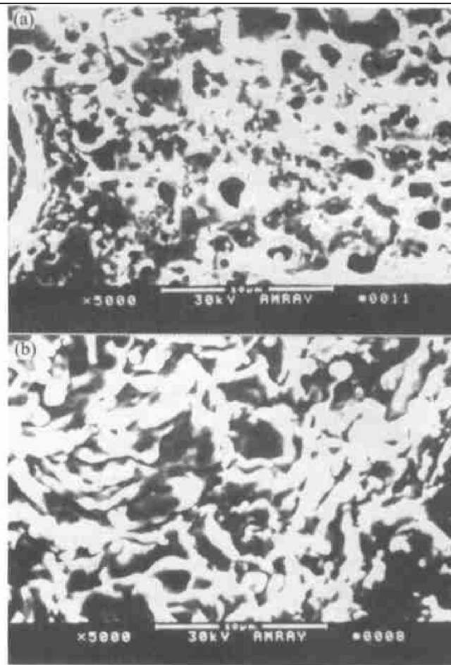
图 8 W-Cu 电触头材料 100 次起弧后的斑点形貌
