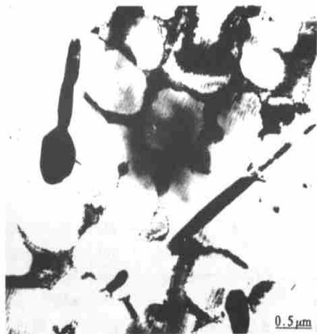
图 4 \delta -NiMo 相的透射电镜(TEM)明场像
