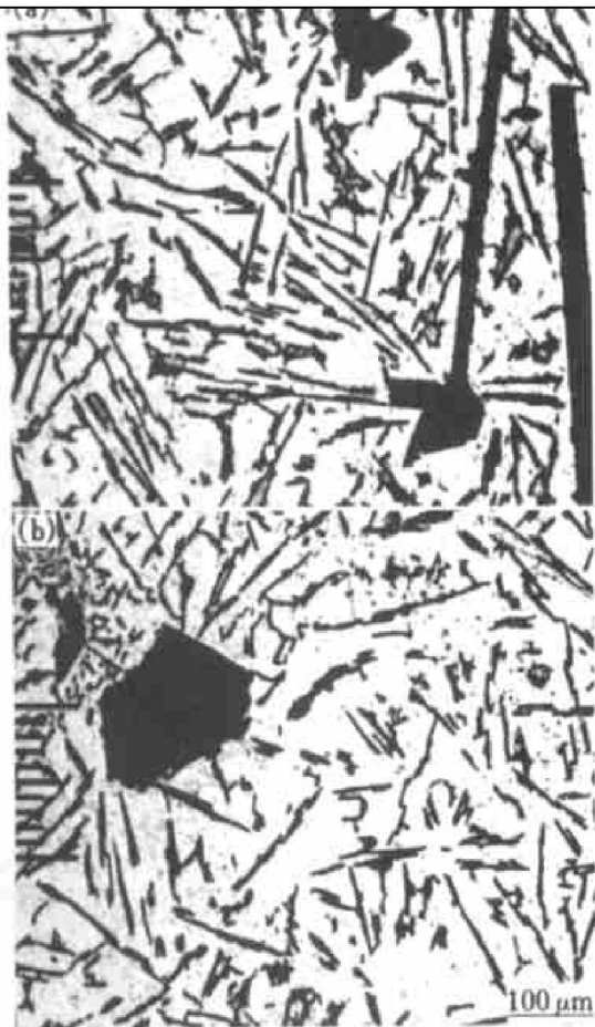
图 4 Al-19Si 合金共晶组织形貌
