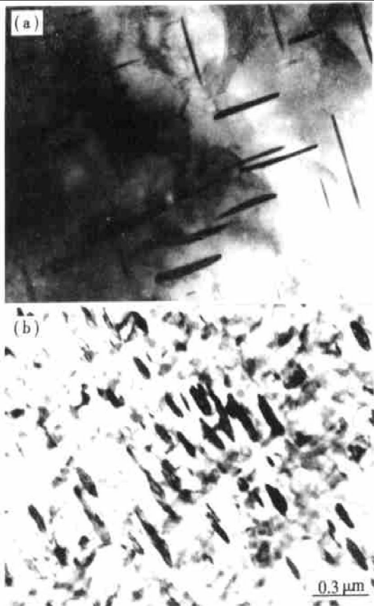
图 8 Mullite/Al-4.45Cu 复合材料 (a) 及 Al-4.45Cu (b) 中 \theta' 析出相的 TEM 像 (250 °C 时效 60 min)
