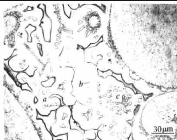
图 4 Cu 75 Co 25 合金试样的金相组织
