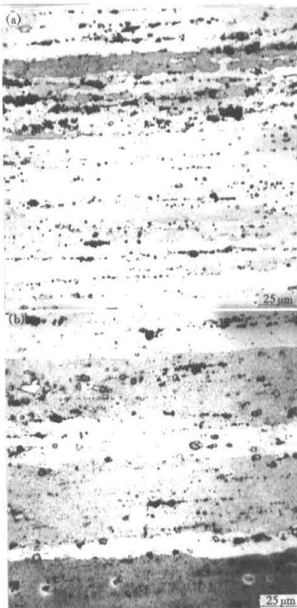
图 2 常规固溶处理(a)及强化固溶处理(b)
