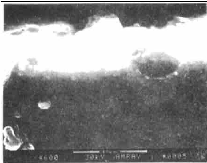
图 3 LY12 铝合金微弧氧化陶瓷层的截面形貌
