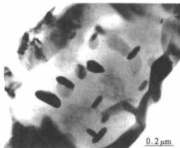
图 4 稀土化合物在 Zr-5Al 合金中的形态(TEM)
