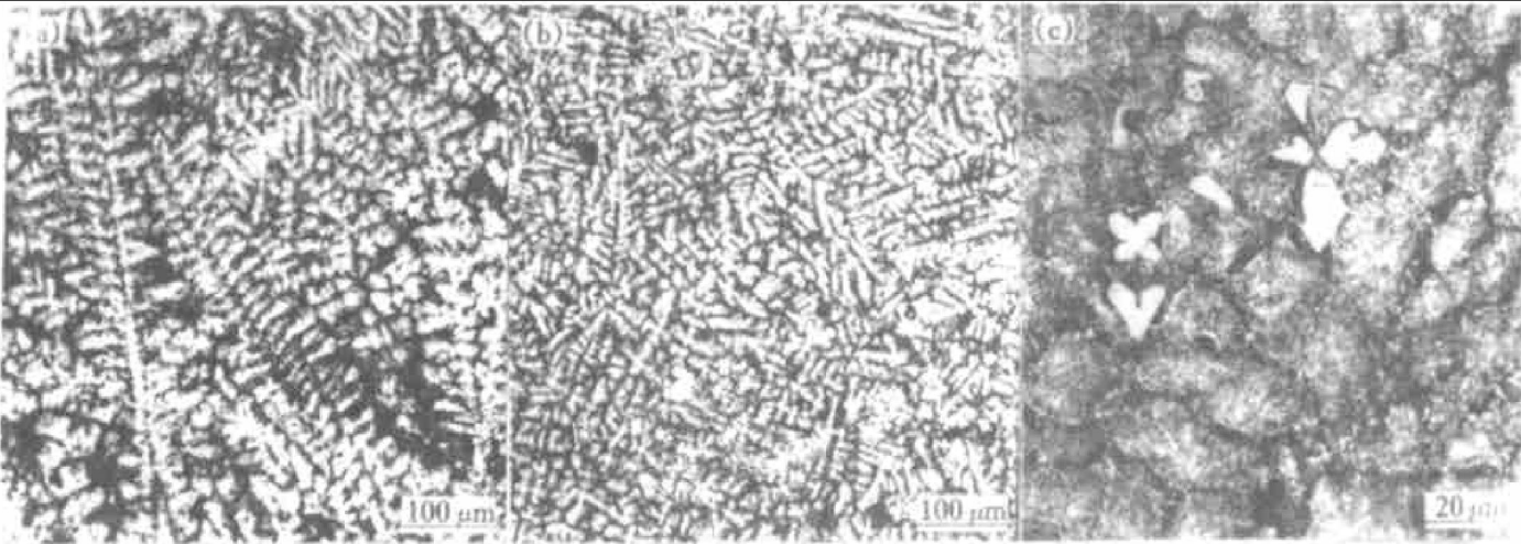
图 1 稀土对 ZA27 合金显微组织的影响 Fig. 1 Effect of RE on microstructures of ZA27 alloy (a) -AlRE 0.3%; (b) -AlRE 0.9%; (c) -AlRE 1.3%
