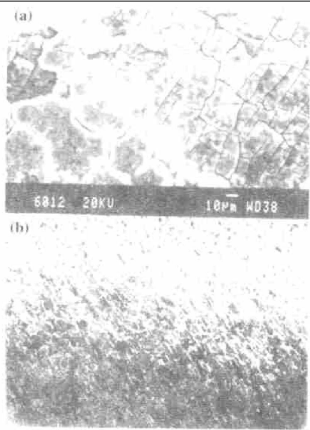
图 4 氧化表面处理卷焊试样的腐蚀形貌
