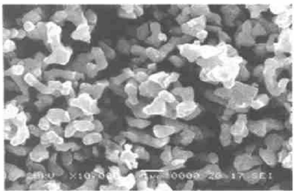
图 20 比电容为 75 mF·V/g 氧化铌粉的形貌
