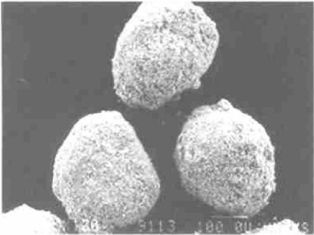
图 11 宁夏公司经预团化工艺生产的钽粉形貌
