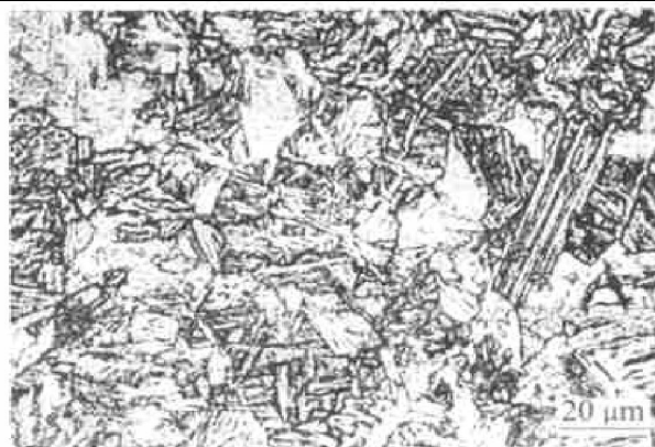
图 12 WDL610D2 钢调质态的光学显微组织
