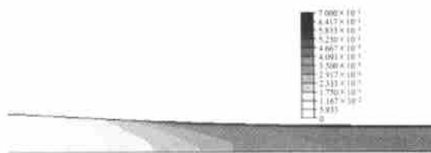
图 9 热轧带钢的累积总剪切应变场 (摩擦因数 0.3)
