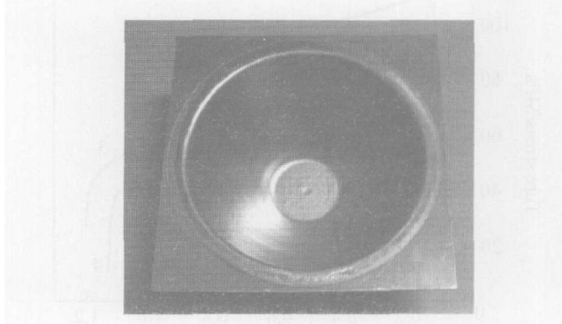
图 5 Al-6Mg-0.2Sc 合金的高应变超塑性胀形零件照片
