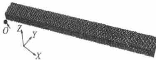
图 4 毛坯的有限元模型 Fig. 4 Finite element model of blank
