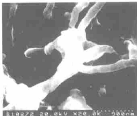
图 8 400 °C 热处理后镍包覆碳纳米管 SEM 像
