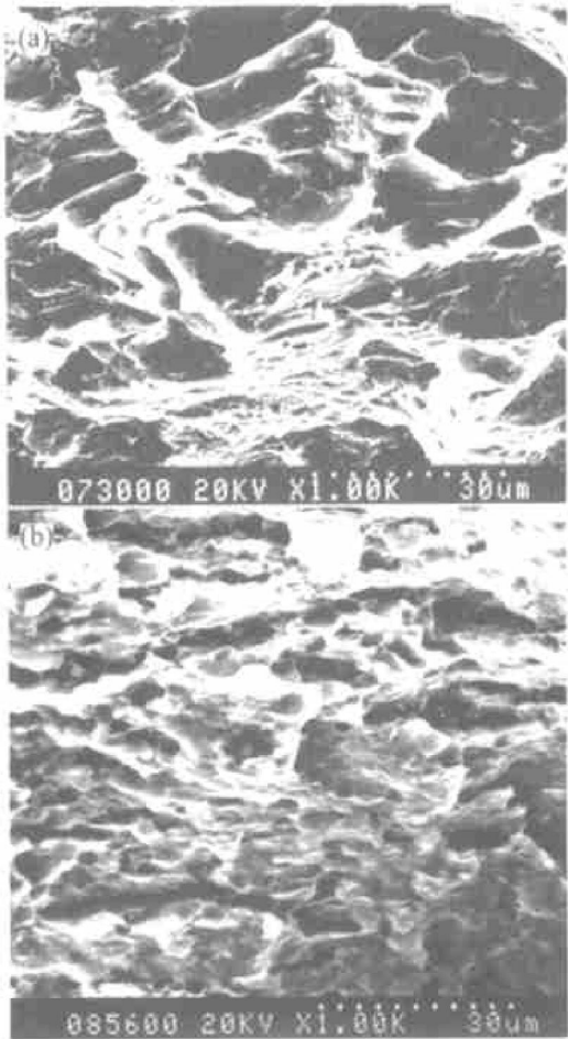
图 6 AZ31 镁合金薄板退火后 室温拉伸断口形貌
