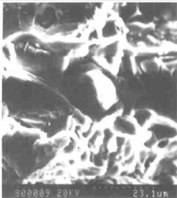
图 7 硅线石颗粒/铝复合材料的拉伸断口形貌
