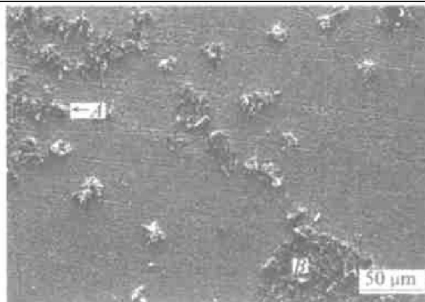
图 6 均匀化 TiAl 合金在 900 °C (Na, K) 2 SO 4 中腐蚀 100 h 后的表面形貌
