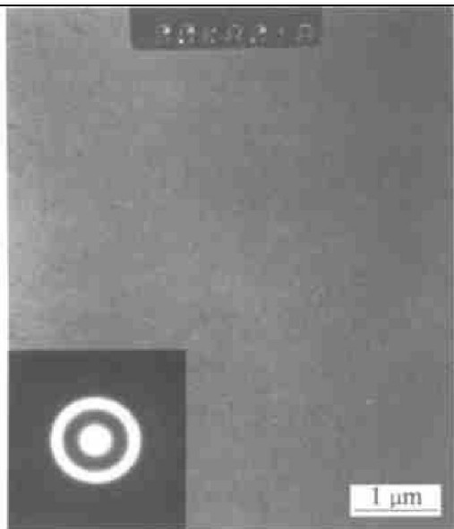
图3 Zr 56.6 Cu 17.3 Ni 12.5 Al 9.6 Ti 4 合金 圆棒试样(横截面)的TEM像及 相应的选区电子衍射花样
