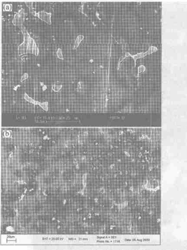
图 4 在纯空气中镁合金表面的微观形貌
