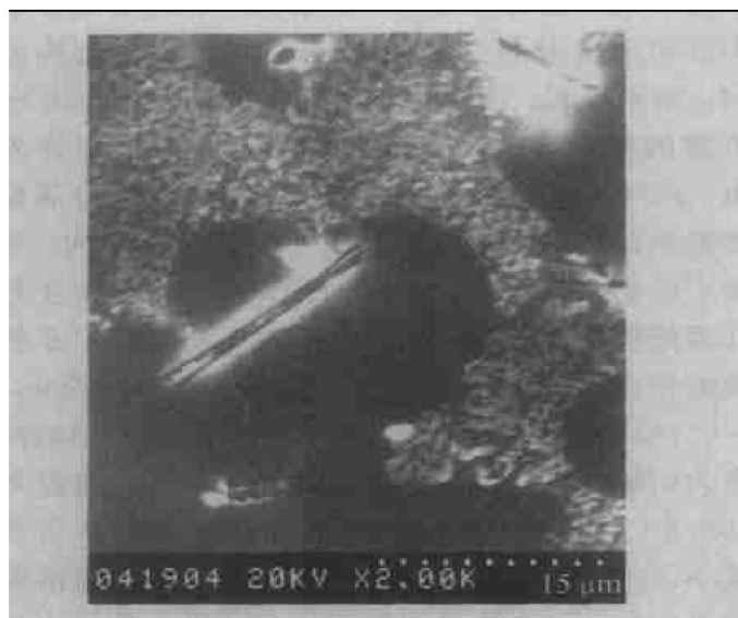
图5 长棒状 ZrAl_3 Fig. 5 Long rods ZrAl_3
