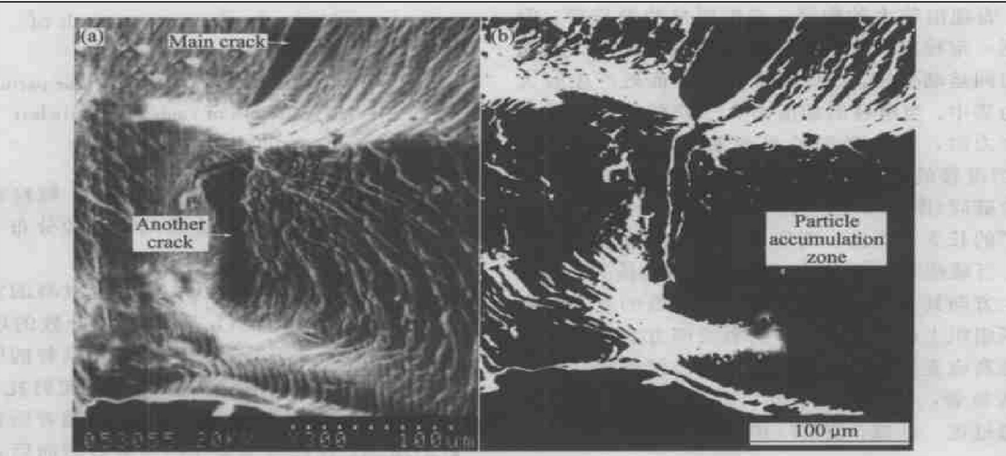
图 6 新裂纹萌生与主裂纹贯通
