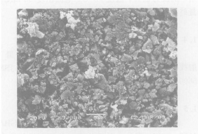
图 4 镁还原产物的 SEM 像
