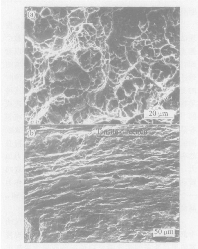
图 5 试样 1 断口和缩颈区侧面的形貌
