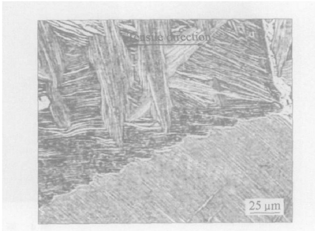
图 8 试样 2 拉伸后的显微组织
