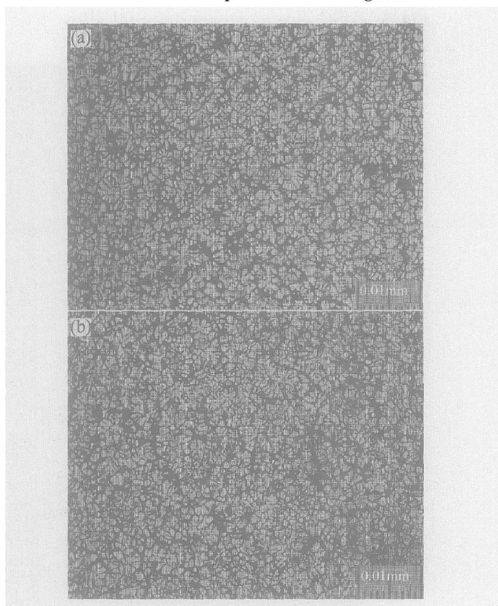
图 6 半固态压铸拉力试棒横断面和纵断面上的微观组织
