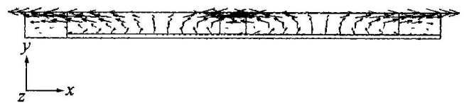
图5 阳极间缝的电解质流场
