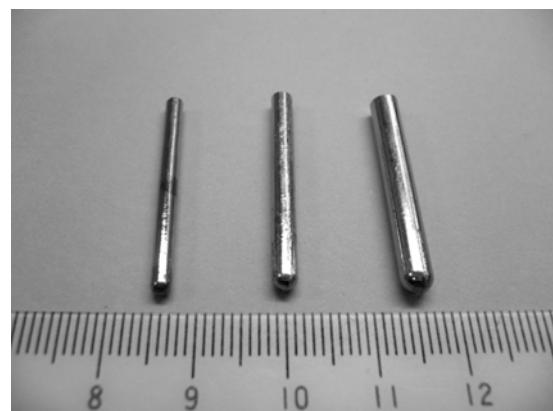
图 4 直径分别为 2、3 和 4 mm 的  $\text{Fe}_{71}\text{Nb}_4\text{Hf}_3\text{Y}_2\text{B}_{20}$  非晶合金棒外观形
