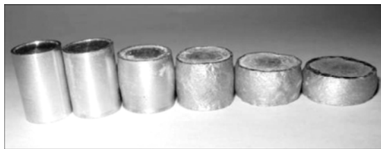
图 1 TiB 2 /6351 复合材料在温度为 300 °C 和应变速率为 10 /s 热压缩过程中形貌变化
